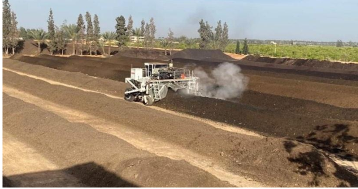
صورة (4) ميكنة تقوم بعملية تقليب، ورش الكومة بالماء لترطيب كومة الكمبوست لخلطها جيدا مما يساعد على تجانس مكونات الكمبوست مصنع سماد الصالح بمدينة الصالحية بالشرقية 2023 /10/1
